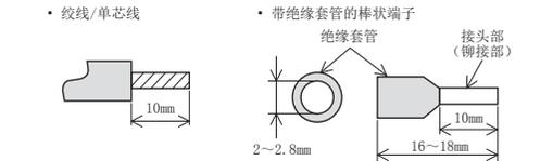
在以下图中，请确认电线插入口形状后，使用尺寸小于插入口的棒型压装端子。同时，请在插入时注意棒型压装端子的方向。违反上述要求时，可能会发生端子阻塞或端子排破损。
