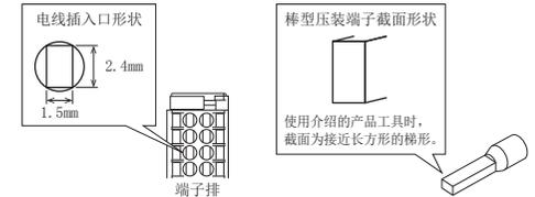
适合端子排的棒型压装端子及棒型压装端子用的工具如下表所示。根据压装工具不同，棒型压装端子的形状有所差异，请使用介绍的产品。如果使用上述以外的其他物件，则可能导致棒型压装端子无法拔出，端子排发生破损的问题，因此请仔细确认棒型压装端子及电线尺寸，确保可以拔出之后再使用。
